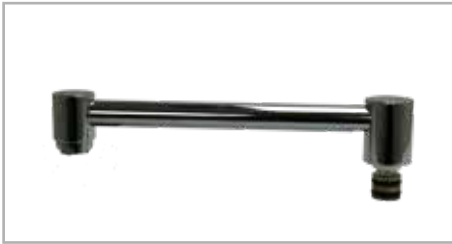
Auslauf 1/2" für Thekenarmaturen (40 mm niedrige Bauhöhe) Strahlregler M24 x 1 AG, steckbar, verchromt, 200 mm Ausladung (für Echtermann-Mischbatterien)
