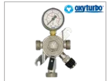
Major Plus m. Sicherheitsventil Zwischendruckregler - 7 bar, 1-leitig
